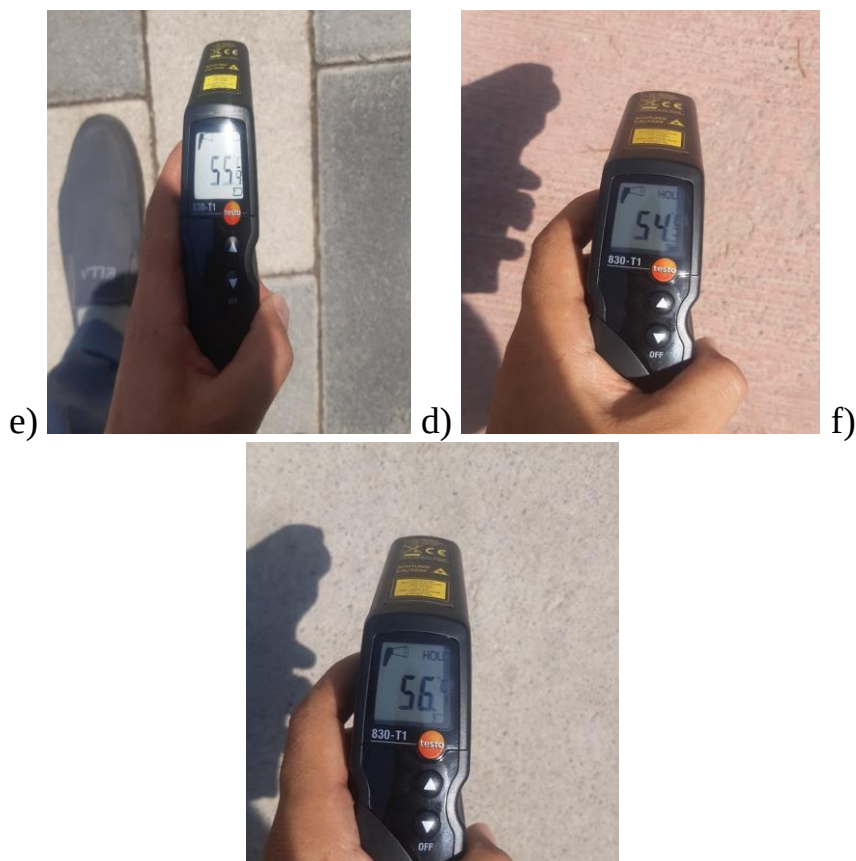
1-rasm. Yoz kunlaridagi qoplamalar haroratining ko‘tarilishi. a) asfalt-beton, b)bo‘yalgan asfalt-beton, c)qora rangdagi bruschatka e) oq rangdagi bruschatka d)bo‘yalgan sement-beton asosidagi yo‘l f) oddiy sement beton yo‘l qoplamalari.
