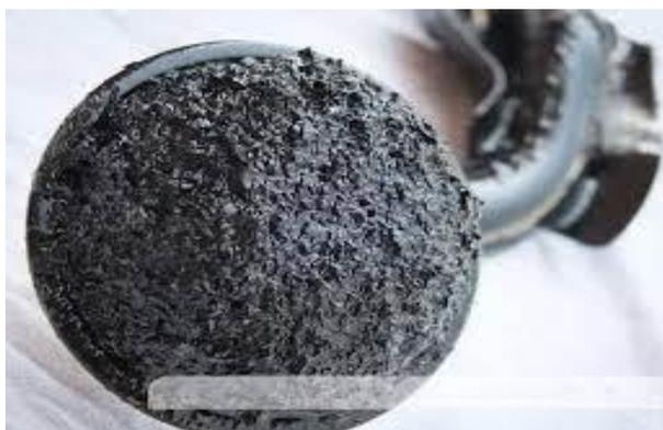
Рисунок 7. Забитая сеточка масляного насоса
