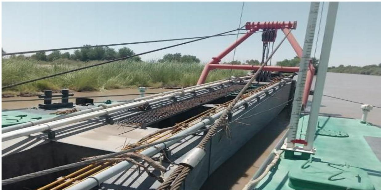
**2-rasm Amu-Buxoro kanalidagi zemsinaryatning ishchi qismi**
