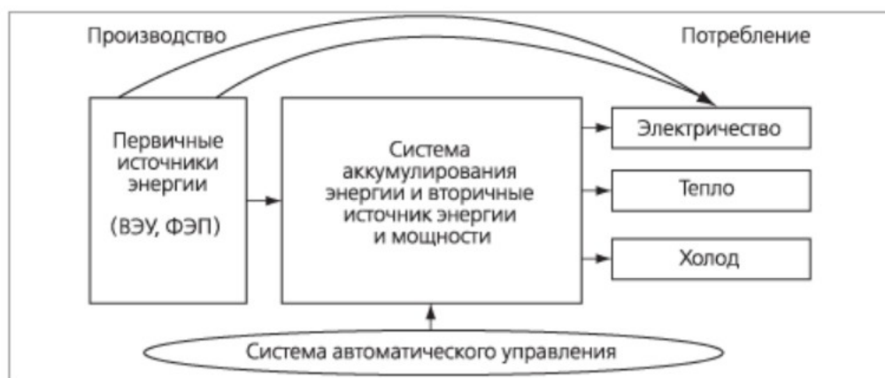
Рис. 1 – Основные компоненты автономной энергоустановки на ВИЭ [1]
