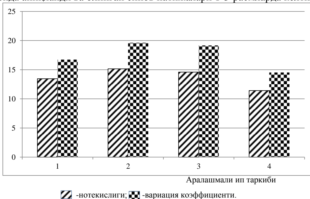
1-расм. Тола таркиби турлича бўлган ипларнинг нотекислик кўрсаткичи ва вариация коэффицентининг ўзгариши.
