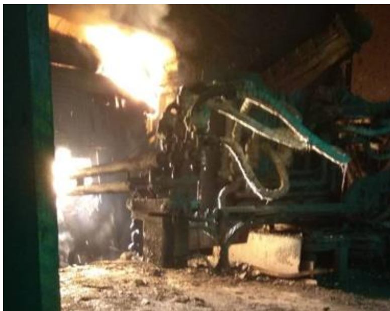
Рисунок 1. Подача газокислородной смеси при помощи дверного манипулятора рабочего окна
