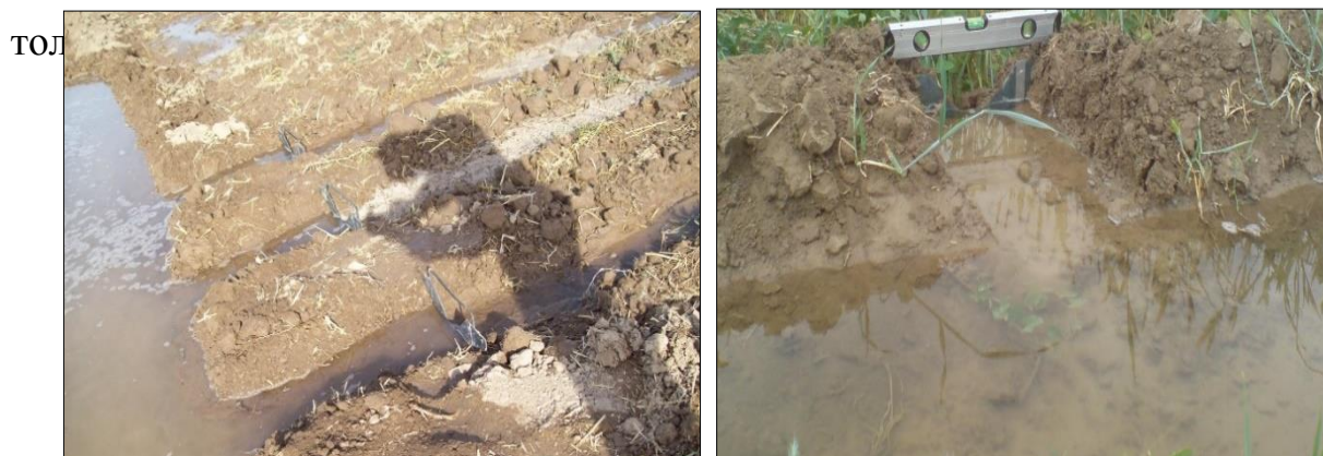
Рис.– 2 Использование водослива Томсона на исследуемом поле участке
