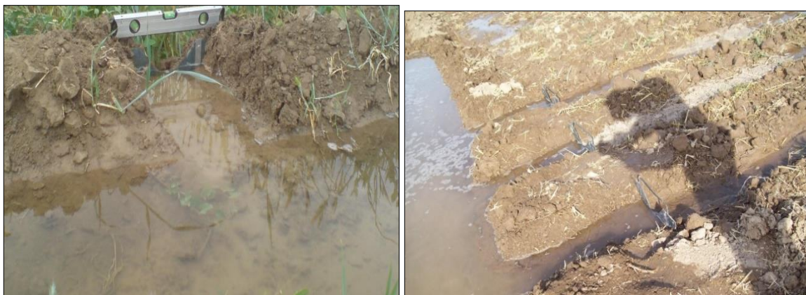
Рис.– 2 Использование водослива Томсона на исследуемом поле-вом участке
