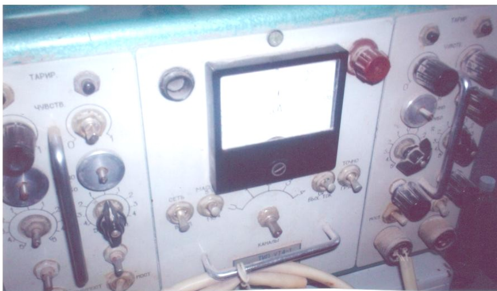
Рис.1.3. Общий вид комплекса электроизмерительной аппаратуры для тензометрирования.
