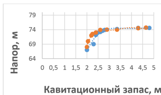
Рисунок 6. Макет насоса, изготовленный методами 3D печати на стенде (а), сравнение расчетной и экспериментальной напорных характеристик (б)
