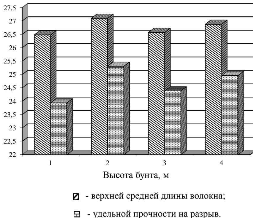
Рисунок 3. Изменение верхней средней длины волокна и удельной прочности на разрыв по высоте бунта.
