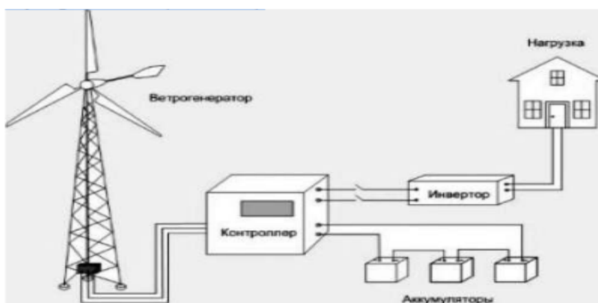
1.2-rasm. Shamol turbinalariga asoslangan elektr ta'minoti tizimining ishlash printsipti.
