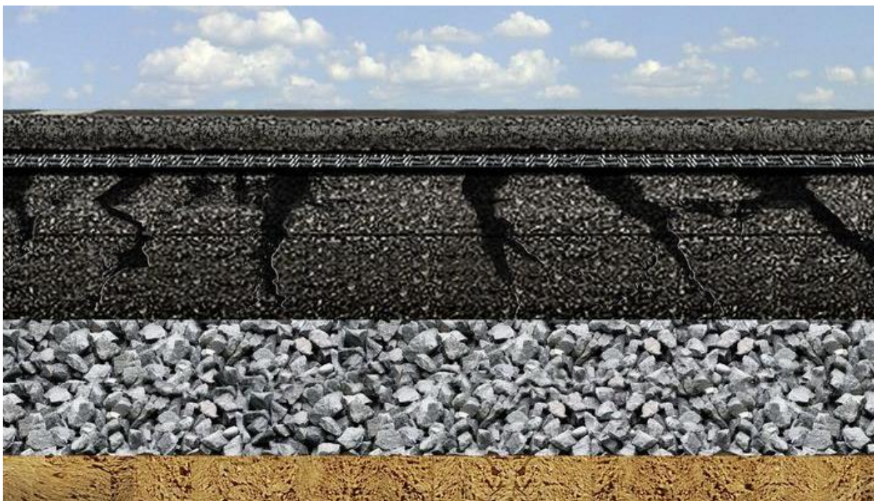
Рисунок-2. Процесс использования георешетки в конструктивных слоях дорожных одежд.
