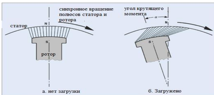
Рис: 1 Относительное положение магнитных полей статора и ротора.
