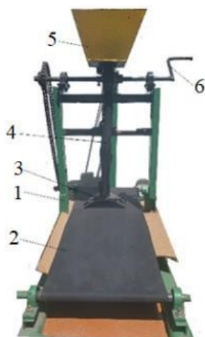
1-расм. Ўғит солгичлар томонидан ўғитларни солиш шакли ва усулини ўрганиш мақсадида махсус қурилма
