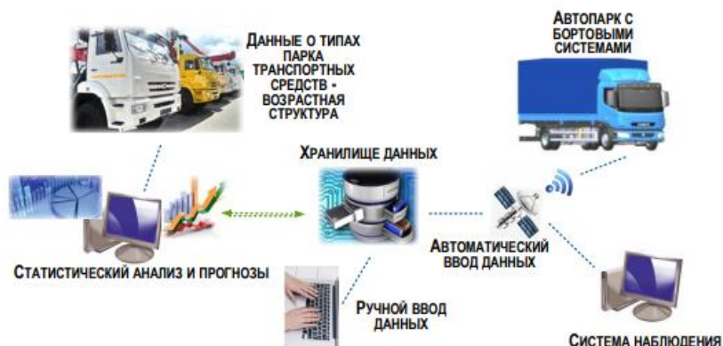
Рис. 1. Концептуальная схема Интеллектуальной Системы для Планирования Сервисного Обслуживания
