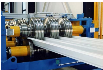
2-расм. Профиластилларни ишлаб чиқарилиши. [2]
