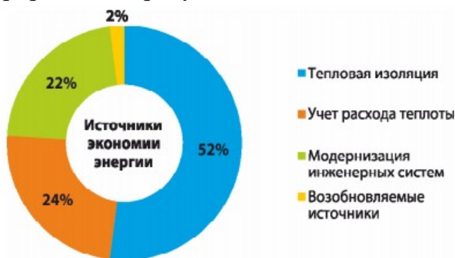
Рис.1. Роль различных мероприятий в общем резерве энергосбережения в зданиях.
