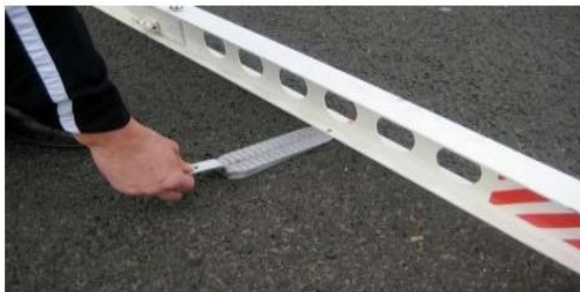
Рисунок 1. Процесс измерения в трехметровой рейке.
