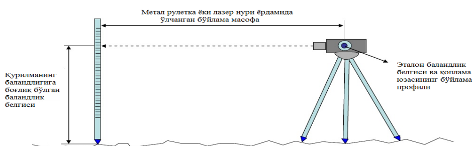
Рисунок 2. Измерение ровности покрытия с помощью нивелира.
