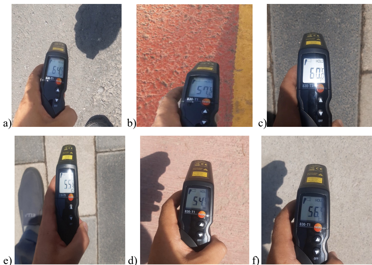
1-rasm. Yoz kunlaridagi qoplamalar haroratining ko‘tarilishi. a) asfalt-beton, b)bo‘yalgan asfalt-beton, c)qora rangdagi bruschatka e) oq rangdagi bruschatka d)bo‘yalgan sement-beton asosidagi yo‘l f) oddiy sement beton yo‘l qoplamalari.
